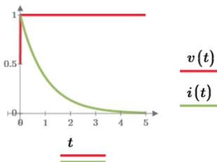
[解] この電流波形をラプラス変換すると、 $I(s) = \frac{1}{s+1} = \frac{\frac{1}{s}}{1+\frac{1}{s}}$  となる。従って、 $E(s) = \frac{1}{s}$ 、 $Z(s) = R + \frac{1}{sC}$ 、 $R = 1\Omega$ 、 $C = 1F$  の RC 直列回路に直流電圧 1[V]を印加したときの直流過渡応答が答えの電流波形となる。
