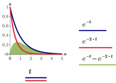
[解] この電流波形をラプラス変換すると、 $I(s) = \frac{1}{s+1} - \frac{1}{s+2} = \frac{1}{(s+1)(s+2)} = \frac{1}{s^2+3s+2} = \frac{\frac{1}{s}}{s+3+\frac{2}{s}}$  となる。従って、 $E(s) = \frac{1}{s}$ 、 $Z(s) = sL + R + \frac{1}{sC}$ 、 $R = 3\Omega$ 、 $L = 1\text{H}$ 、 $C = \frac{1}{2}\text{F}$  の RLC 直列回路に直流電圧 1[V]を印加したときの過渡応答が答えの電流波形となる。
