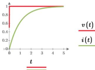
[解] この電流波形をラプラス変換すると、 $I(s) = \frac{1}{s} - \frac{1}{s+1} = \frac{1}{s(s+1)} = \frac{\frac{1}{s}}{1+s}$  となる。従って、 $E(s) = \frac{1}{s}$ 、 $Z(s) = R + sL$ 、 $R = 1\Omega$ 、 $L = 1H$  の RL 直列回路に直流電圧 1[V] を印加したときの直流過渡応答が答えの電流波形となる。
