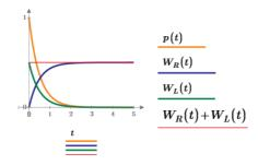
t=0 において 1A が流れていた RL 回路の電源 off の過渡現象と同じ結果 となる。また、R で消費したエネルギーと L に蓄えられているエネルギーの 和は常に一定であり、それは最初に L が有していたエネルギーである。
