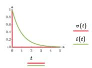
[解] この電流波形をラプラス変換すると、 $I(s)=\frac{1}{s+1}$  となる。従って、Z(s)=R+sL、 $R=1\Omega$ 、L=1H の RL 直列回路にインパルス電圧を印加すると答えの過渡電流波形となる。
