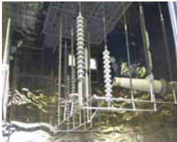
人工加速劣化試験
