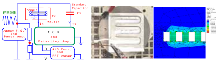
図1. 高電界誘電特性測定系と表面設置くし形電極系
