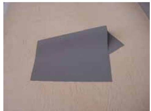
図3. 熱伝導シート(熱伝導率 5W/mK)
