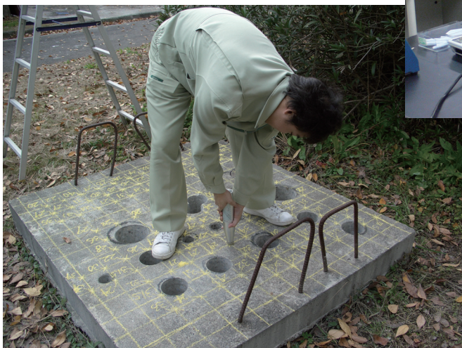
コンクリートの非破壊試験
