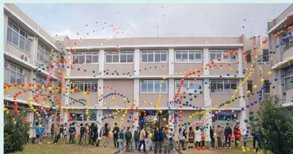
▲岐阜高専校舎の気流可視化
