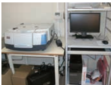
フーリエ変換赤外分光装置（Thermo Science, iS50 FT-IR）
