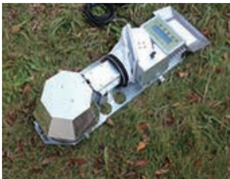
土壌呼吸測定装置 ((株) 英弘精機製ACEステーション)
