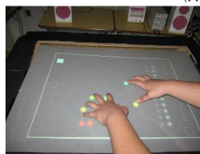
(B) 赤外線センサを使ったマルチタッチスクリーン
