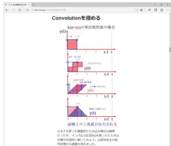
図2. 単位矩形波入力時のインパルス応答が単位矩形波である回路応答の解説(三角波が出力される)
