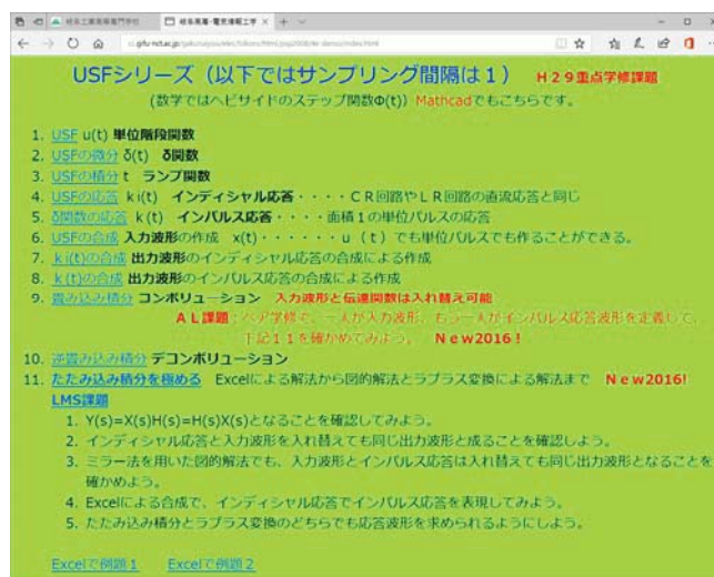
図1. 単位階段関数(USF)による波形応答の解説
