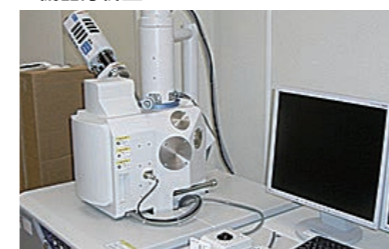
走査型電子顕微鏡 (日立ハイテック、S-3400)
