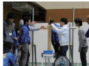
全国高専デザインコンペティション(課題の木製タワーを振動台に設置)
