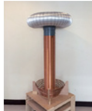
学生作品テスラコイル (数十万ボルトの発生が可能な発電装置)
