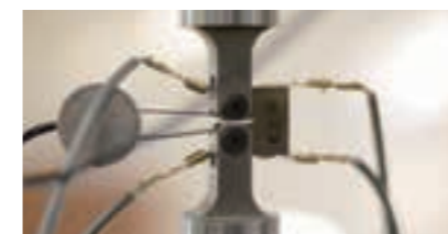
金属材料の疲労試験
