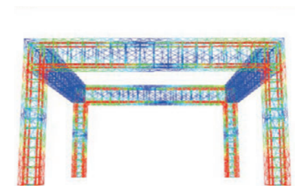
鉄筋コンクリート造骨組の精密解析
