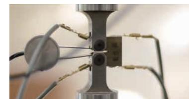
金属材料の疲労試験
