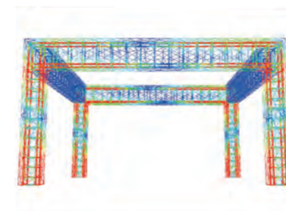
鉄筋コンクリート造骨組の精密解析
