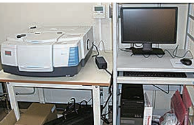
フーリエ変換赤外分光装置
