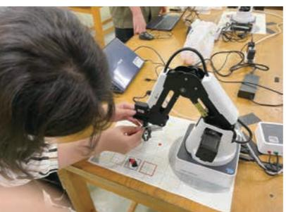
画像処理を利用したロボット制御
