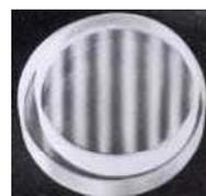
測定時の干渉縞(平面)
