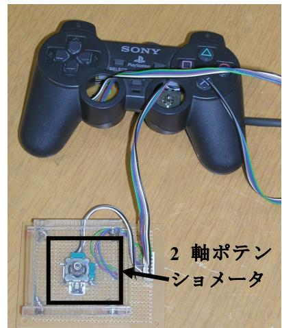
図4 プレイステーションコントローラに使用されるポテンショメータ
