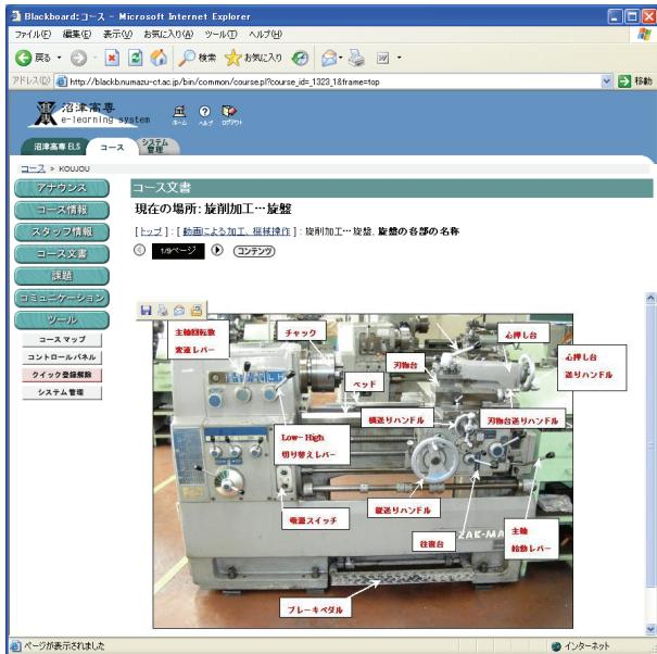
図2 旋盤の解説のコンテンツ
