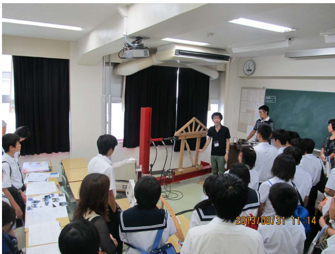
（建築学科「木造すじかい骨組の水平加力実験」）
