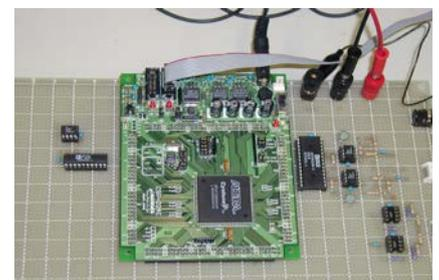
図3 信号処理用 FPGA ボード
